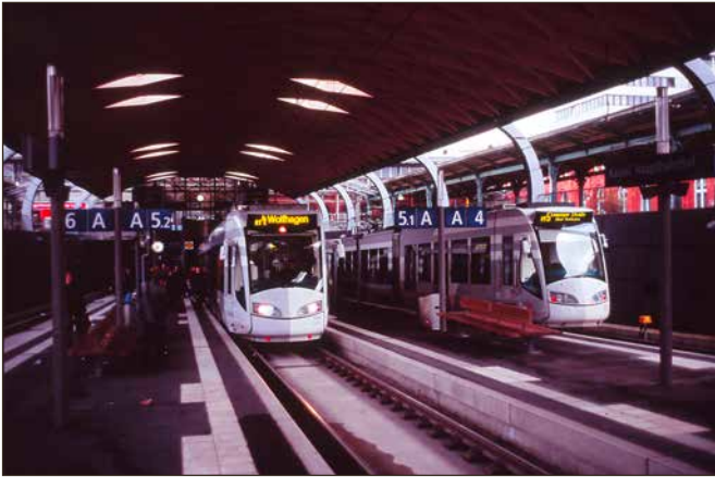
Mitten in der Bahnhofshalle hält die Straßenbahn – erst wenn sie auf die Bahnstrecken wechseln, werden aus den Tram-Trains formal Eisenbahnen.
