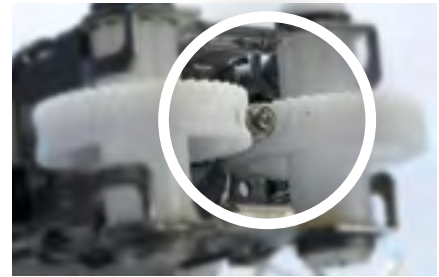
Plastikzahnräder verschleißen schneller als solche aus Metall. Da hält der Mixer nicht sehr lange. Foto: Kirsten Breustedt, www.murks-nein-danke.de
