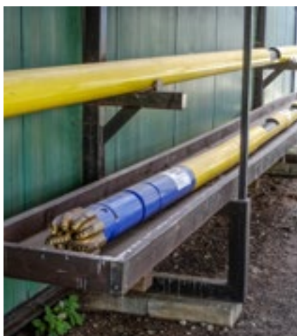
Moderner Bohrer, mit dem man auch Kurven in der Tiefe und genau zielgerichtet bohren kann.
