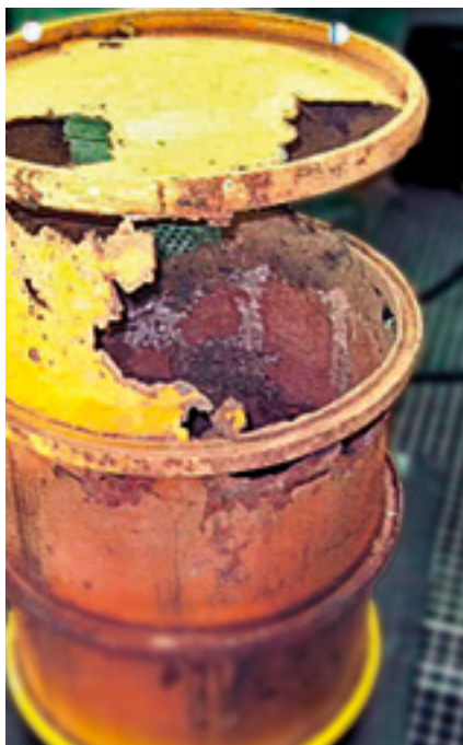
So sehen manche Atommüllfässer aus nach einigen Jahrzehnten im Zwischenlager Brunsbüttel.
