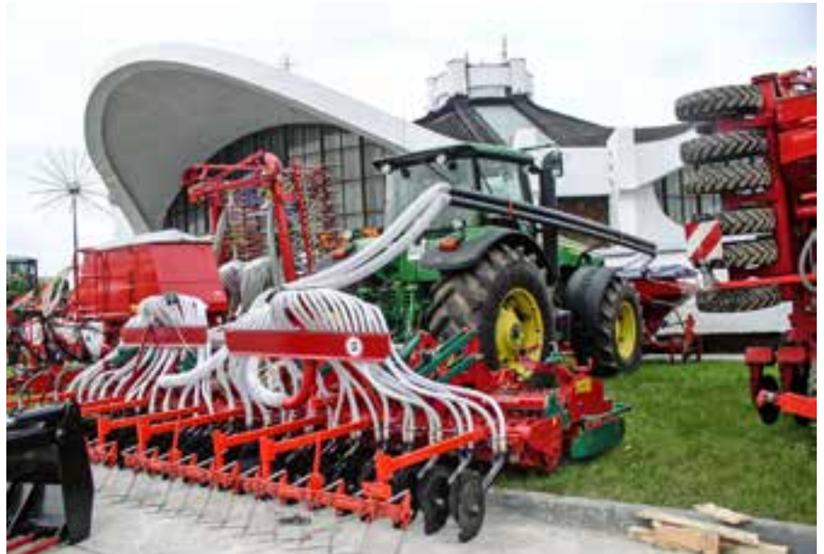
Moderne Drillmaschinen (Sämaschinen) arbeiten hydraulisch, das Korn wird in die Erde geblasen. Je nach Art der Abluftführung kommen mehr oder weniger Beizmittel in die Atmosphäre.
