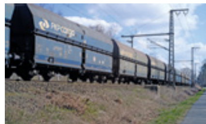
Alte Güterwagen machen viel Krach, abgefahrene Fahrwerke, alte Bremsen sorgen für einen entsprechenden Lärmpegel, der Anwohner quälen kann.
