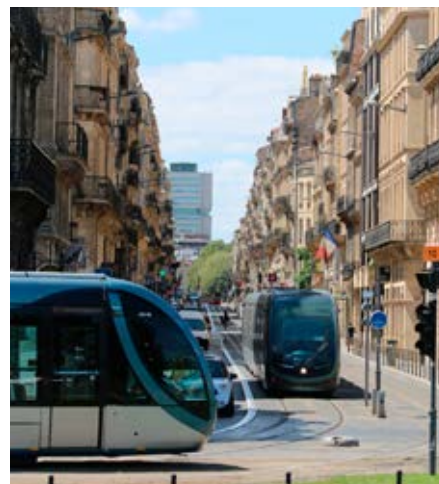
Bordeaux gehörte zu den Pionieren der Straßenbahnrenaissance in Frankreich. Dort fahren die Trams in der City ohne Oberleitung, aber nicht mit Batterie, sondern gespeist durch ein Stromschienensystem im Gleis.
