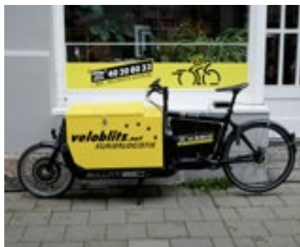
Und hier der Blaumann: Pedelec-Lastenfahrrad (Typ Vargo eBike iBullitt) schafft auch mehrere Zentner Nutzlast – ideal für Transporte in der Stadt und Kurierdienste.
