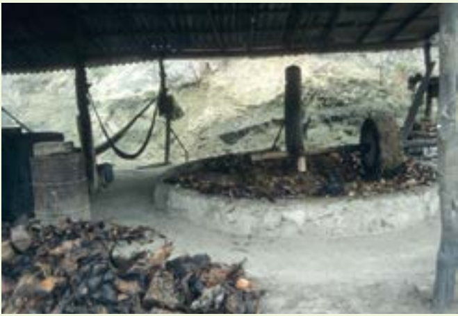
Für die Herstellung von Tequila und Mezcal werden die gerösteten Agavenherzen in einer von Pferden oder Eseln angetriebenen Mühle zermahlen.
