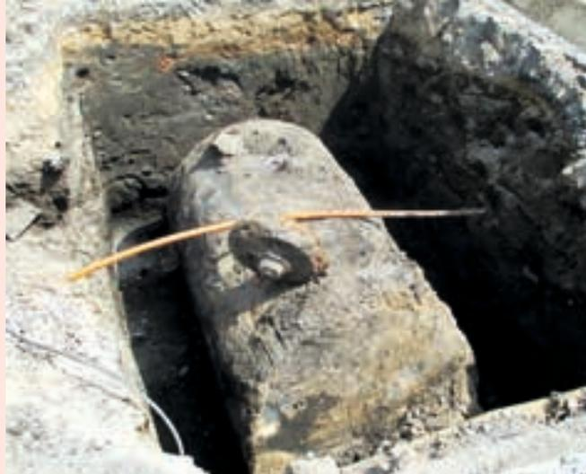
Eine Bodenverunreinigung kann durch einen verrotteten Tank verursacht werden.
