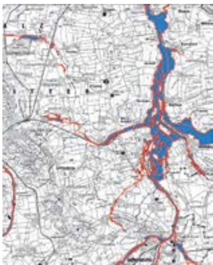
In blau sind die Überschwemmungsgebiete ober- und unterhalb Schladens eingetragen. Diese Flächen an der Oker haben Ende Juli ein schlimmeres Hochwasser in Braunschweig und Wolfenbüttel verhindern helfen.
