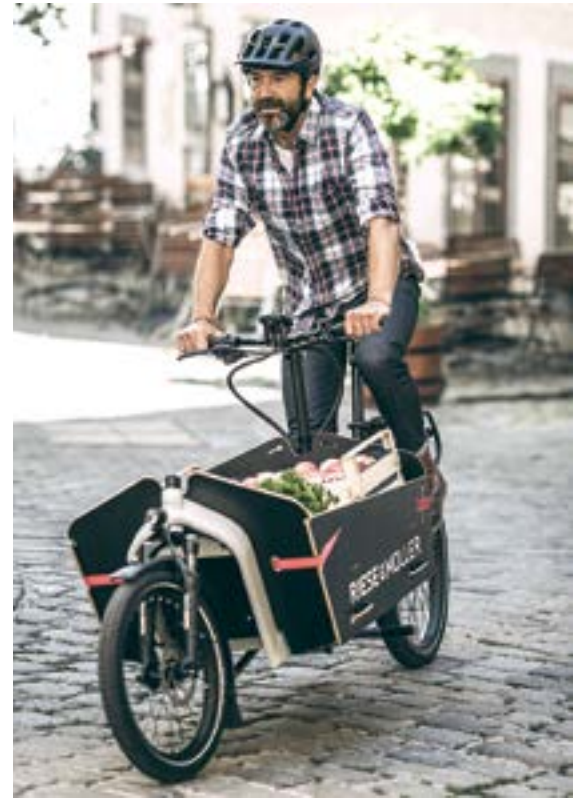
Das „Packster-80“. Ein E-Lastenrad mit Bosch-Antrieb und bis zu 1.000 WH Akkukapazität.
