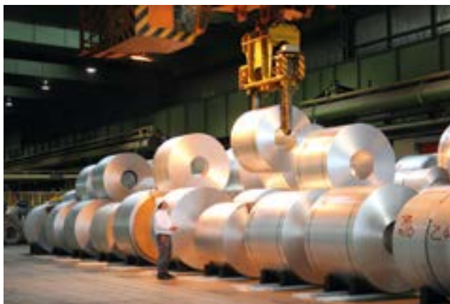
Sogenannte Coils („Spulen“) bestehen aus aufgerolltem Blech: ein Endprodukt. Daraus werden in der Automobilproduktion Karosserieteile geformt.
