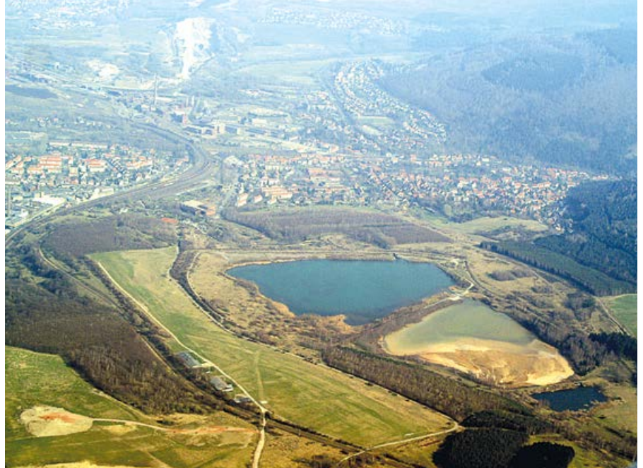
Luftbild des Bollrichs bei Goslar-Oker (2007). Klärteich der ehemaligen Rammelsberger Erzaufbereitung mit gelben Einspülungen von Neutralisationsschlämmen der Rammelsberger Sauerwässer – Altlast und Sekundärlagerstätte. FOTO: KLAUS STEDINGK
