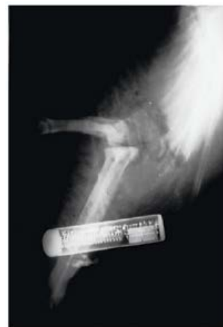
Dieser Logger im Magen eines Königpinguins notiert, wo und wann Nahrung aufgenommen wird.
