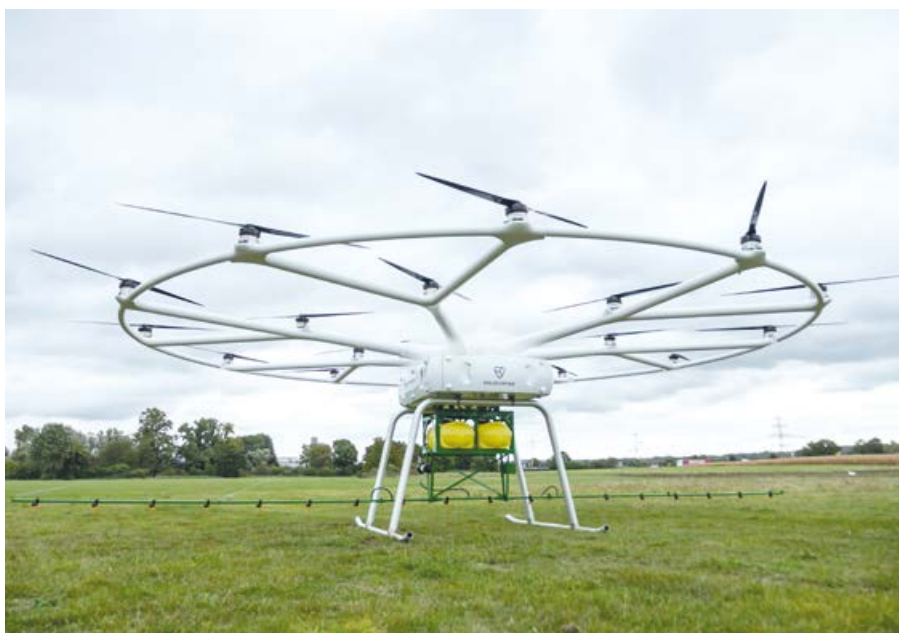
Die Volo-Drone – eine Kooperation von John Deere mit Volocopter – ist mit ihren 9,20 Metern Durchmesser und 200 kg Zuladung für den künftigen landwirtschaftlichen Betrieb ausgelegt.
