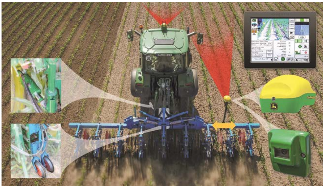
Die Hackmaschine des Traktors ist kameragesteuert, erkennt nicht gewünschte Pflanzen und hackt sie individuell aus - bei 16 km/h.
