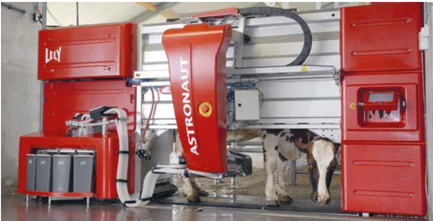
Der Roboter reinigt das Euter und startet den Melkvorgang automatisch.
